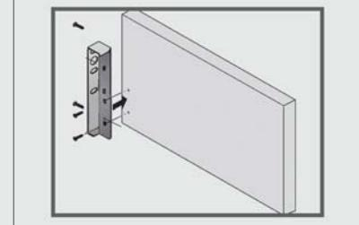
۳. کف کشو را مطابق شکل زیر به بدنه کشو پیچ نمایید.
