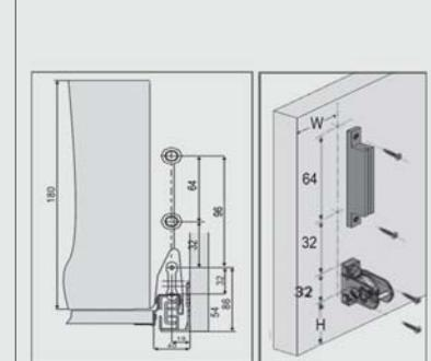
W/(عرض درب - عرض یونیت) - (ضخامت ورق بدنه یونیت)(+) ۱ میلیمتر
